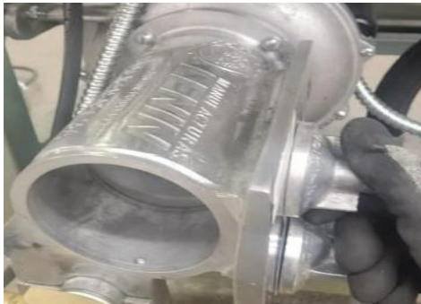
K Girar perilla superior de la válvula carburadora para ajustar el aire.
