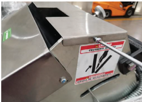
A Retirar tornillos de guarda con resaque
